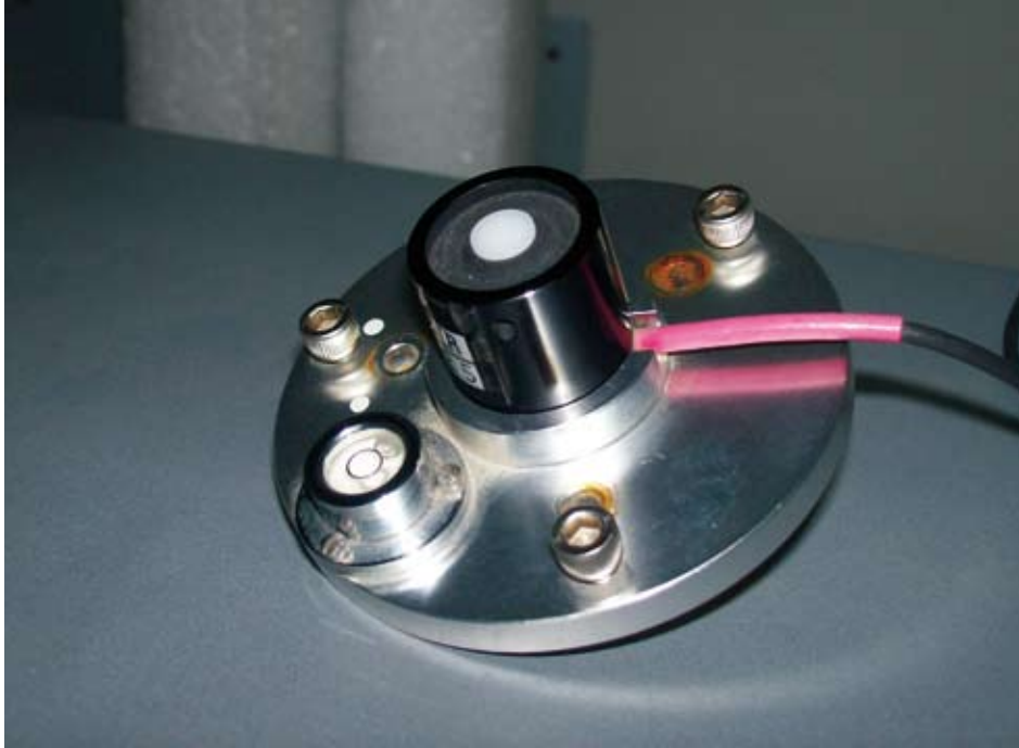
“Estaciones meteorológicas”, sensor de radiación “Meteorological Stations”, radiation sensor
